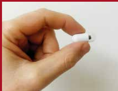
Kleine Kapsel-Kamera für die Video-Endoskopie
